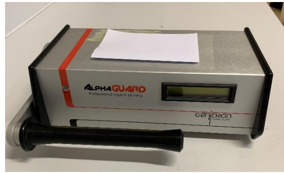
Abb. 4 – Alpha-Guard. Zeitauflösendes Messgerät.
