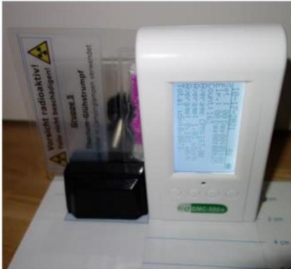
Abb. 4: Versuch 4 (Abstandsmessung) - Quelle: Versuchsanleitungen zum Messkoffer
