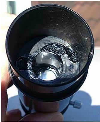
**Abb.15:** Durch Sonne beschädigtes Teleskop (Sternenwarte Kassel 2012)
