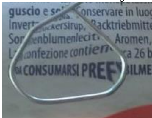
Abb. 9 - Lupe aus Büroklammer geformt mit einem Tropfen Wasser
